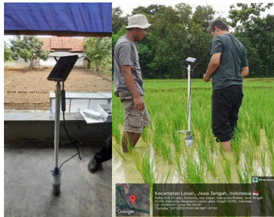
Gambar 30. Pemasangan Alat AWD Otomatis
