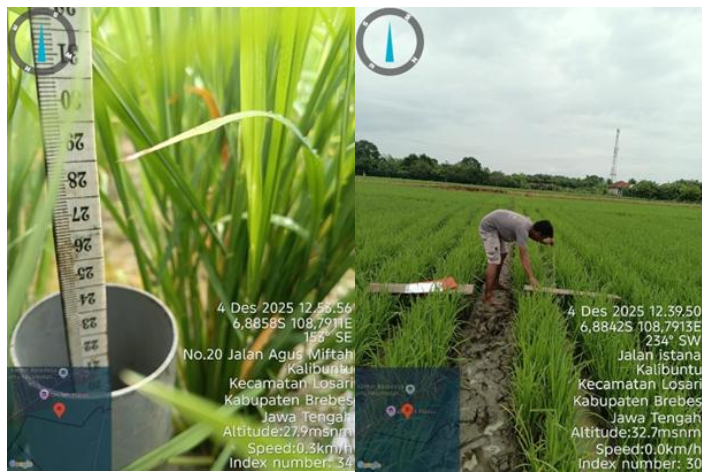
Gambar 29. Pengamatan AWD dengan Alat Pizometer
